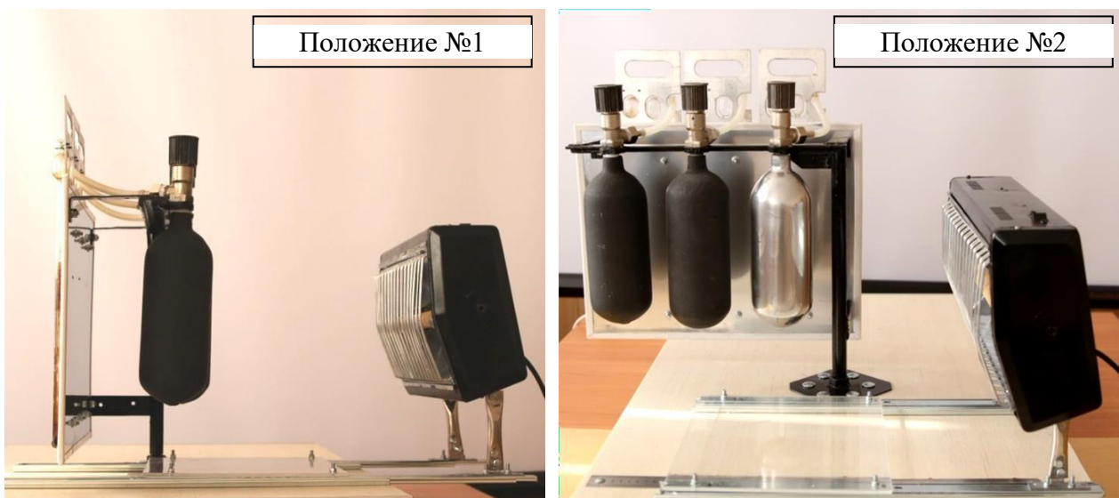
Рисунок 2.6. Рабочие положения экспериментальных сосудов
