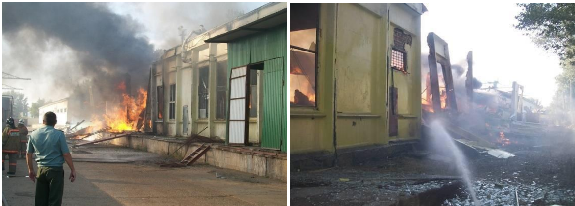
Рисунок 1.1. Последствия воспламенения паров ЛВЖ при пожаре в цехе по приготовлению винилацетатного клея
